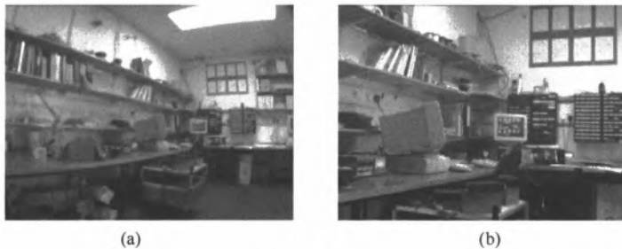
图 7.4 (a)短焦距对(b)长焦距. 注意在(a)中外围的弯曲图像线是场景直线的图像.
