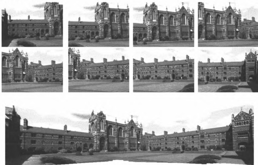
图 8.9 平面全景拼图. 由便携式摄像机绕其中心拍摄的(三十幅中的)八幅图像. 这三十幅图像用平面单应配准并形成一幅全景拼图. 注意“蝴蝶领结”式的特征形状, 这是因为与图像序列的中间一幅图像配准的缘故.
