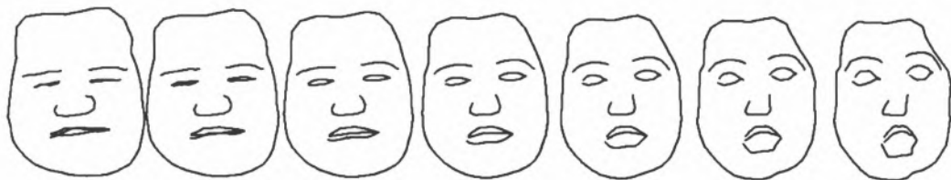
图 18.1 形状基. 人脸模板由 N (这里 N=140 ) 个等间距的 2D 点表示. 七幅中中间的脸是平均形状, 而向左或向右的脸分别是通过加减基形状来产生的, 表示在训练集中的最大变化. 这里, 基的表情从惊讶变化到不满. 面部表情是通过用模板跟踪一个演员的脸部来学习的, 这里他仅变换表情但不改变头部姿态. 训练序列的每一帧产生 N 个 2D 点, 并且这些点的坐标被改写为一个 2N 维向量. 然后由这些向量组成 2N \times f 矩阵, 其中 f 是训练帧的数量, 而基形状由这个矩阵的奇异向量来计算. 承蒙 Richard Bowden 提供图.
