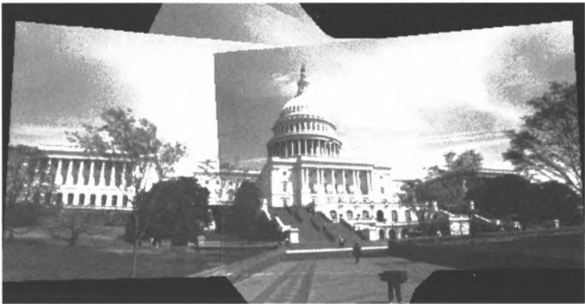
图 19.3 标定绕其中心旋转的摄像机。(下图)由这 5 幅图像构成的拼接图像(见例 8.14)。拼接图像非常清楚地显示了图像之间无穷单应的失真效果。这种失真分析为自标定算法提供了基础。标定按算法 19.3 计算。(续)
