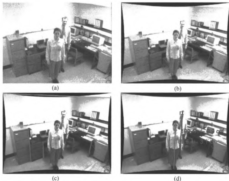
图 8.21 基于仿射性质的高度测量。(a)原始图像。我们想测量两个人的身高。(b)径向失真校正后的图像(参见 7.4 节)。(c)消影线(已显示)由对应于水平方向的两个消影点计算。还显示了用于计算竖直消影点的直线。竖直消影点并未显示,因为它位于图像下方。(d)利用图像左侧文件柜的已知高度,按算法 8.1 所述方法测量两个人的绝对高度。测量的高度在真实值的 2cm 以内。[Criminisi-00]中介绍了不确定性的计算。
