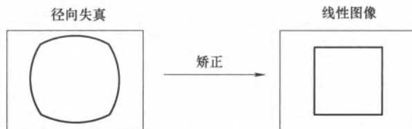
图 7.5 一个正方形的严重径向失真的图像被矫正成就像由理想的线性镜头所获得的图像.
