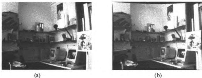
图 7.6 径向失真的矫正. (a) 原始图像, 在此图像中世界直线的像是弯曲的. 其中的若干条线用虚线标注. (b) 消除径向失真的图像形变插补. 注意现在图像外围的线是直的了, 但图像的边界却弯曲了.
